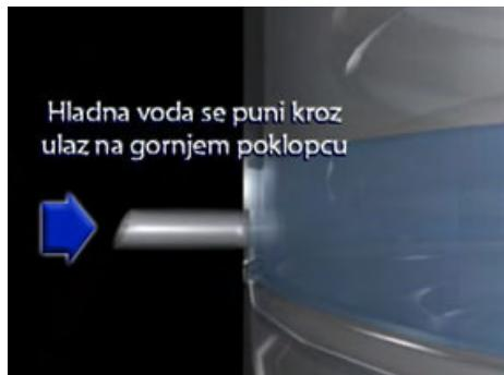
1. Nakon priključenja rashladne vode na kondenzator (donji priključak na kome piše HLADNA VODA ULAZ) pustiti hladnu vodu da ulazi u kondenzator.
